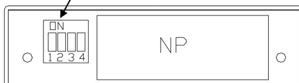
\* 4の PoE 受電モードスイッチは接続する給電機器の種類(at/bt)によって切り替えます。
